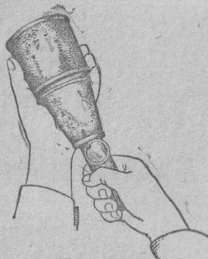
Рис. 15. Свинчивание рукоятки с корпуса гранаты
