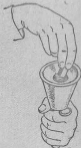
Рис. 16. Навинчивание запала на штуцер
