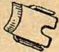
Рис. 10. Выбрасыватель и его пружина
