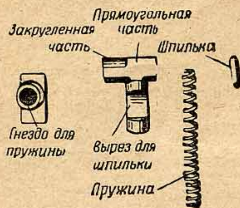
Рис. 18. Гнеток спускового крючка
