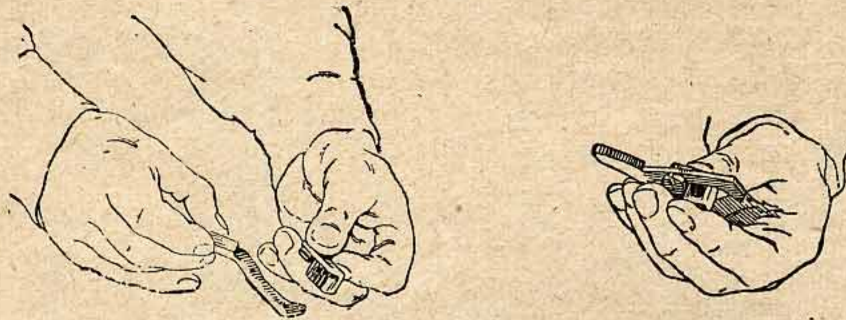
Рис. 49. Как соединить разобщитель с основанием
